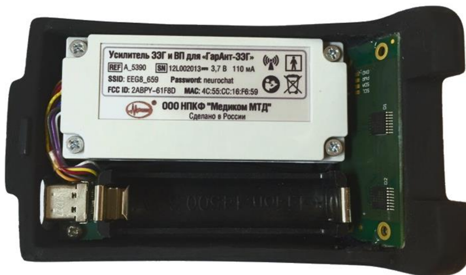
Рисунок 24. Блок усилителя нейрогарнитуры без акб и нижней крышки.
